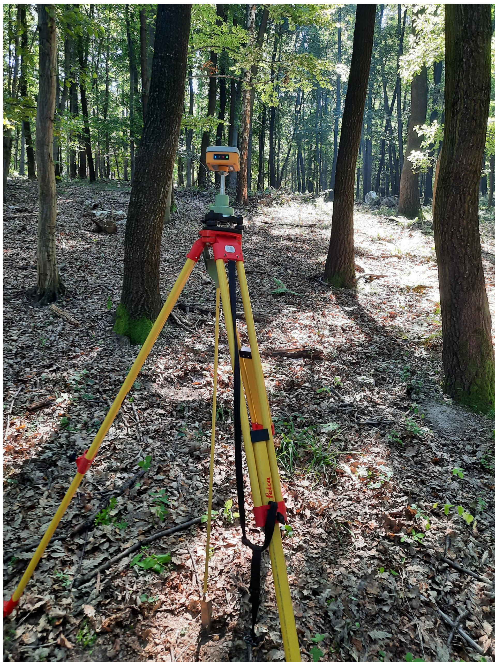
2. ábra: Az állandó sugarú mintakörök középpontjának bemérése GNSS RTK módszerrel
