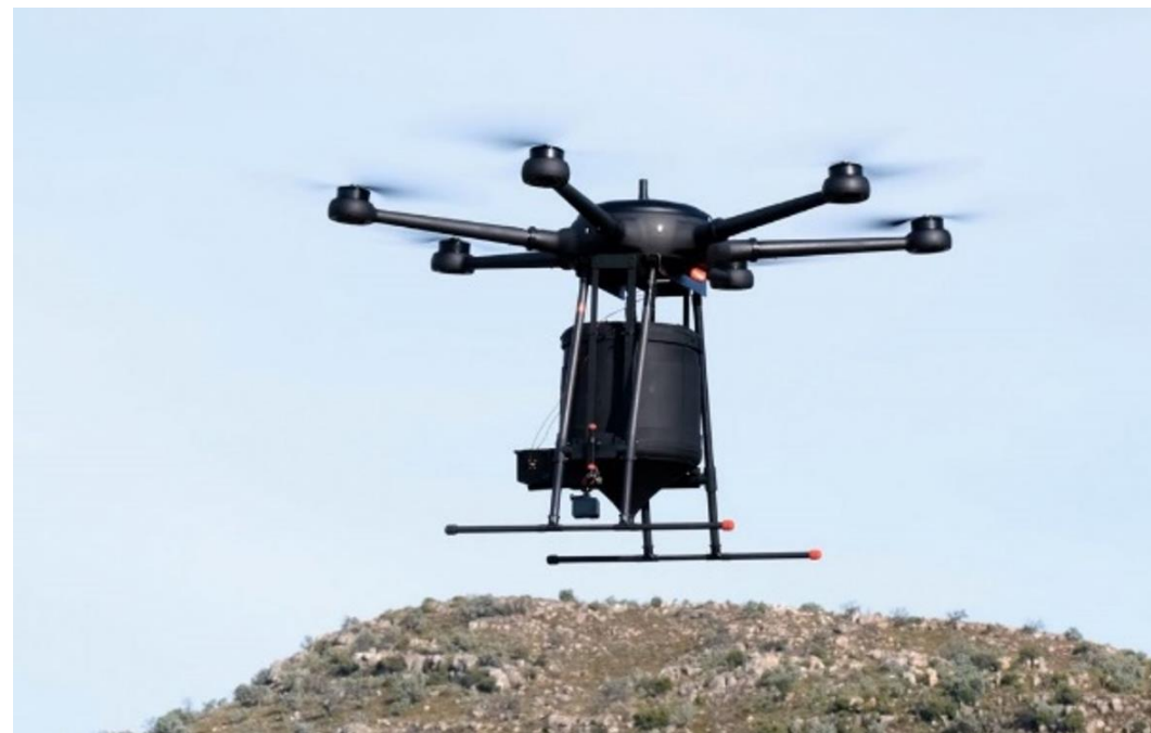
Vetőszerkezettel szerelt drón
