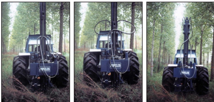
11., 12., 13. ábra: a POPULUS FIH 2,5T Brazíliában, működés közben. Az első szezonról szóló beszámoló alapján két műszakban, napi átlag 4,23 hektárt telepítettek vele, ez 90,61 gödör/óra és 1358 gödör/nap.
