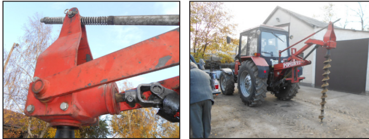
15., 16. és 17. ábra: „POPULUS „R” 1,7” fúrás egyes fázisai közben a „Pletenyik” Kft. gépismertető szóróanyagából. Látható, hogy a fúrószár teljesen függőlegesen mozog.
