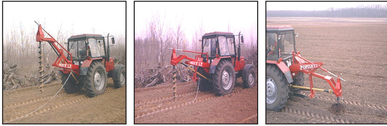
15., 16. és 17. ábra: „POPULUS „R” 1,7” fúrás egyes fázisai közben a „Pletenyik” Kft. gépismertető szóróanyagából. Látható, hogy a fúrószár teljesen függőlegesen mozog.
