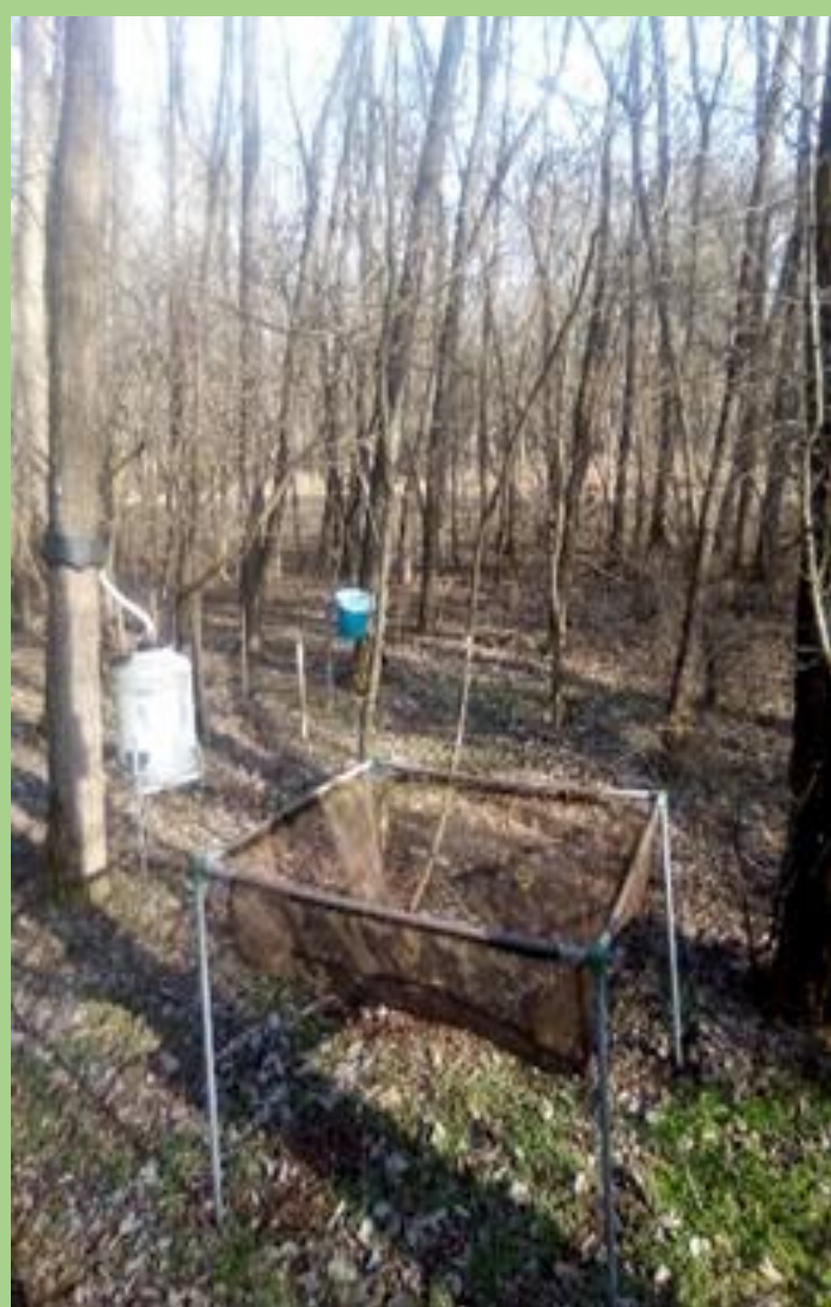
3. ábra: A mintaterületen lévő vizsgált fákhöz kapcsolódó mérőeszközök (fanedváramlás-mérő, törzsi lefolyás mérése, biomassa háló, növekedésmérő-szalag).
