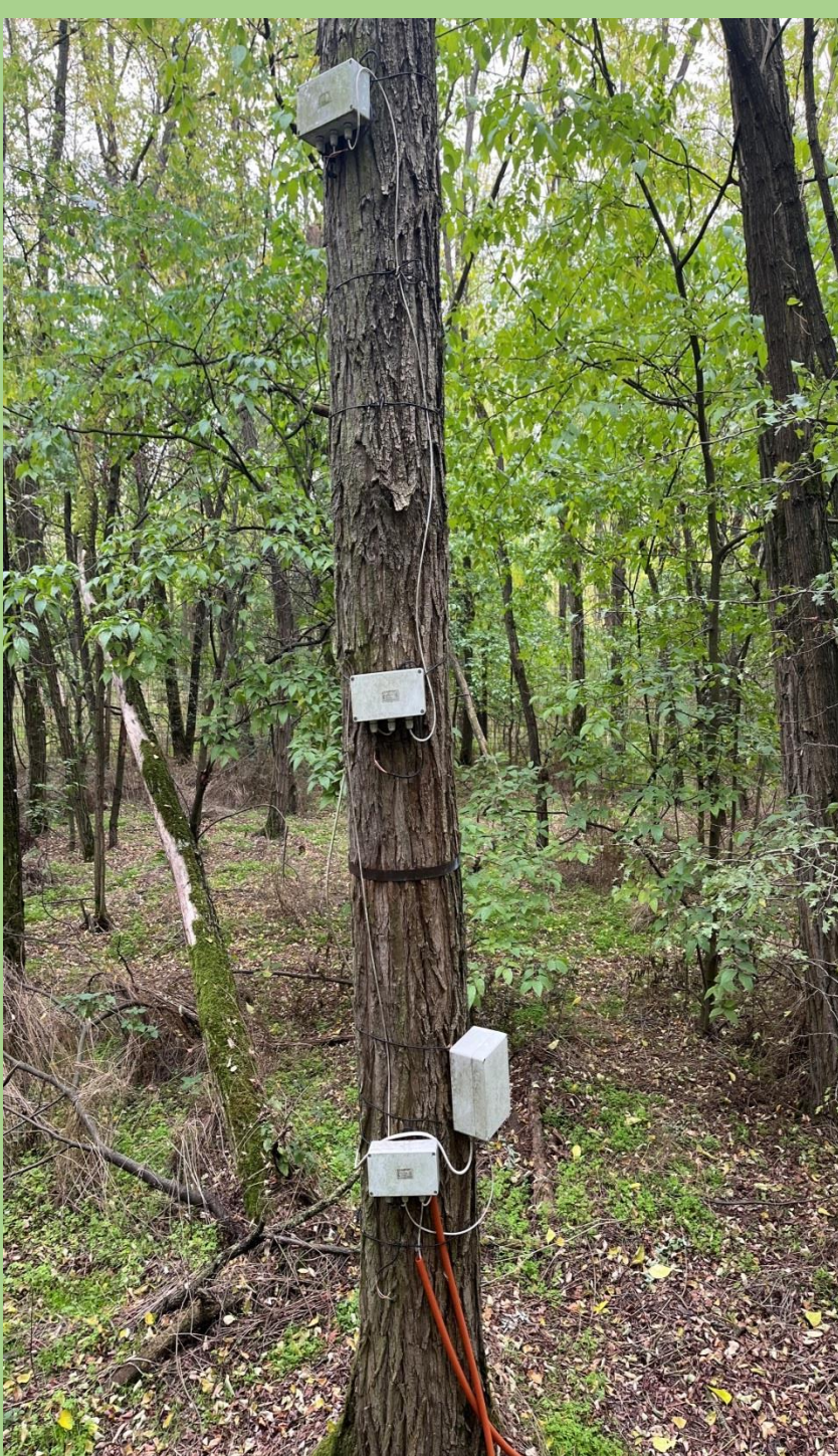
3. ábra: A mintaterületen lévő vizsgált fákhöz kapcsolódó mérőeszközök (fanedváramlás-mérő, törzsi lefolyás mérése, biomassa háló, növekedésmérő-szalag).
