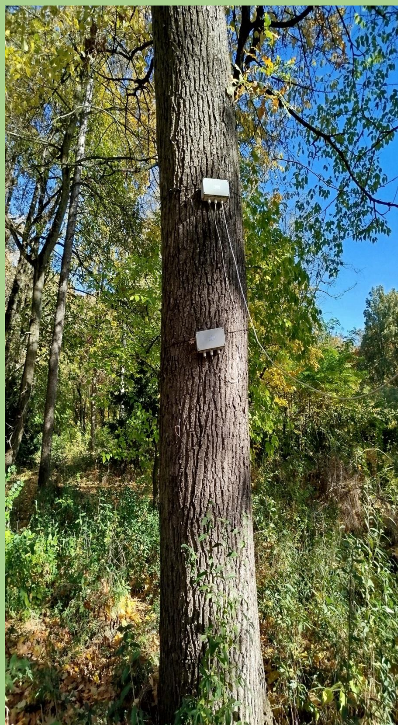
3. ábra: A mintaterületen lévő vizsgált fákhöz kapcsolódó mérőeszközök (fanedváramlás-mérő, törzsi lefolyás mérése, biomassa háló, növekedésmérő-szalag).
