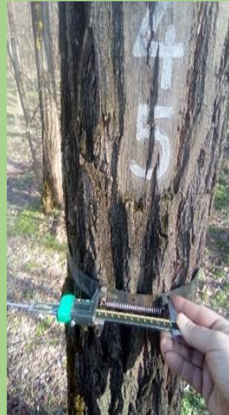
3. ábra: A mintaterületen lévő vizsgált fákhöz kapcsolódó mérőeszközök (fanedváramlás-mérő, törzsi lefolyás mérése, biomassa háló, növekedésmérő-szalag).
