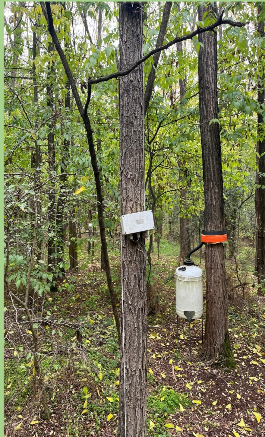
3. ábra: A mintaterületen lévő vizsgált fákhöz kapcsolódó mérőeszközök (fanedváramlás-mérő, törzsi lefolyás mérése, biomassa háló, növekedésmérő-szalag).
